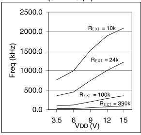
FIGURE 11-4: TYPICAL RC OSCILLATOR FREQUENCY vs. VDD (CEXT = 300pF)
