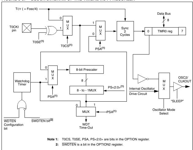
FIGURE 6-6: BLOCK DIAGRAM OF THE TIMERO/WDT PRESCALER
